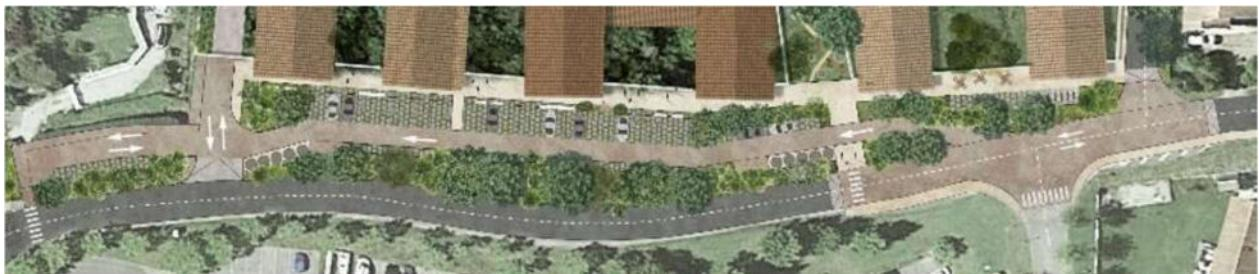
Sur le chemin Irruritea, un élargissement du chemin à 5 mètres est prévu pour améliorer la circulation des véhicules, notamment des véhicules de secours. Ces travaux d'élargissement pourront être réalisés sur une durée d'un mois maximum tout en préservant les accès aux habitations et en organisant le chantier pour limiter les nuisances (odeurs, poussières, circulation).
